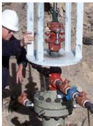
泵可快速直接安装在井口油管或套管
