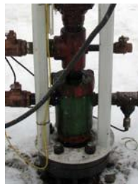
泵可快速直接安装在井口油管或套管
