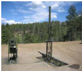
泵可快速直接安装在井口油管或套管
